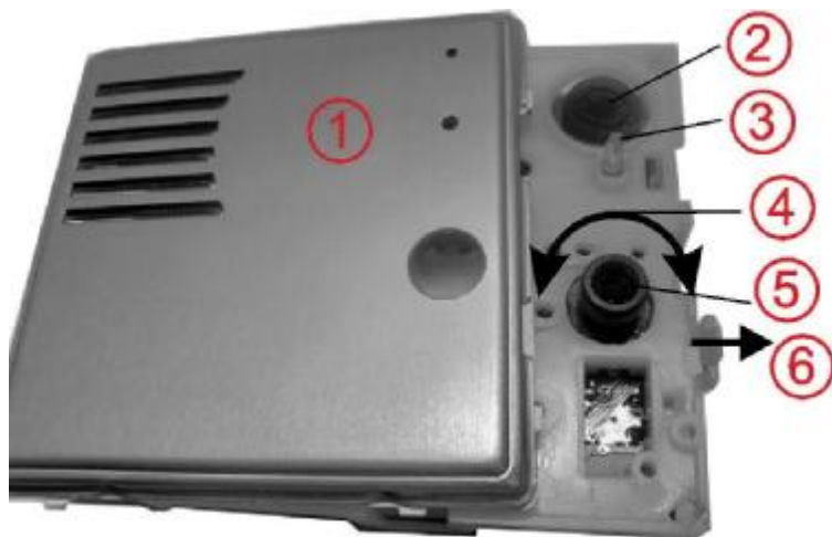
Obrázek 8 přední panel základního modulu IPDP
