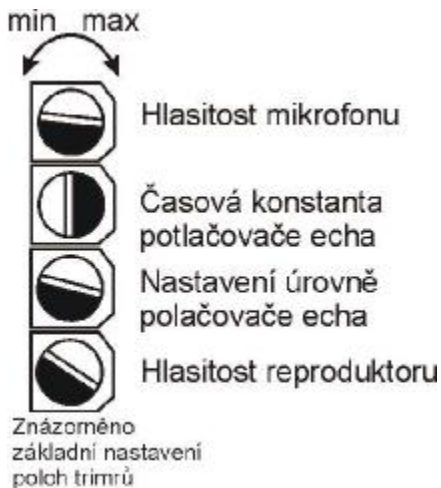
Obrázek 3 Nastavení trimrů
